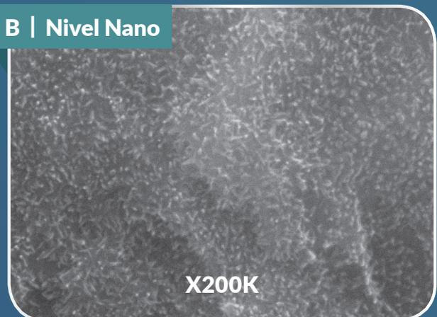
Imágenes SEM de aumento x15K de un implante arenado y grabado en ácido (A) frente a un aumento x200K de la superficie NiNA (B), que muestra las estructuras de TiO<sub>2</sub> en la superficie del implante.
